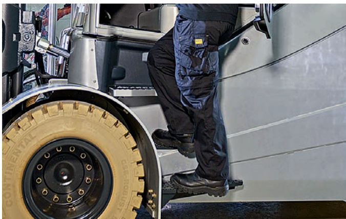
Salita e discesa in sicurezza con l'utilizzo di gradini visibili dall'alto, antisdrucolo
