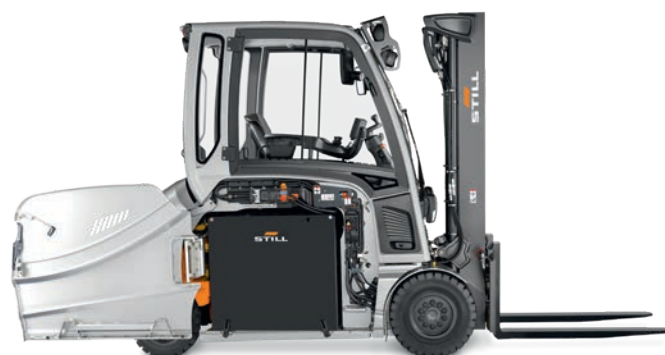
Disponibilità ottimale grazie al rapido cambio della batteria
